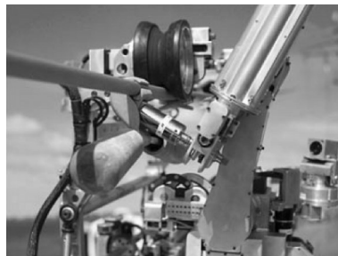
图7 巡线机器人安装导线压接管
