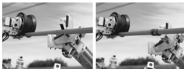
(a) 巡线机器人夹钳 (b) 完成修补工作
